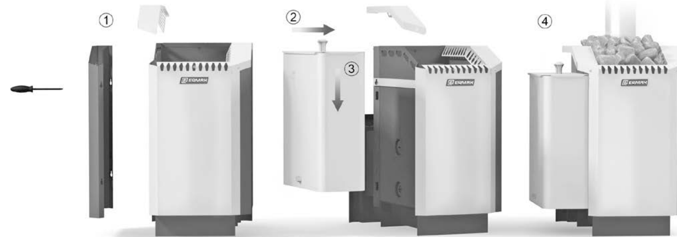
Рисунок - 8. Последовательность установки бака для нагрева воды
